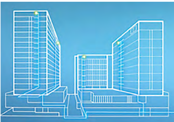
Een voorbeeld van een bedrijfsgebouw met een uitgebreid watersysteem. Het kan moeilijk zijn om het kritieke punt te bepalen, dus maximaal zes druksensoren zijn genoeg om het hele systeem te bewaken.
