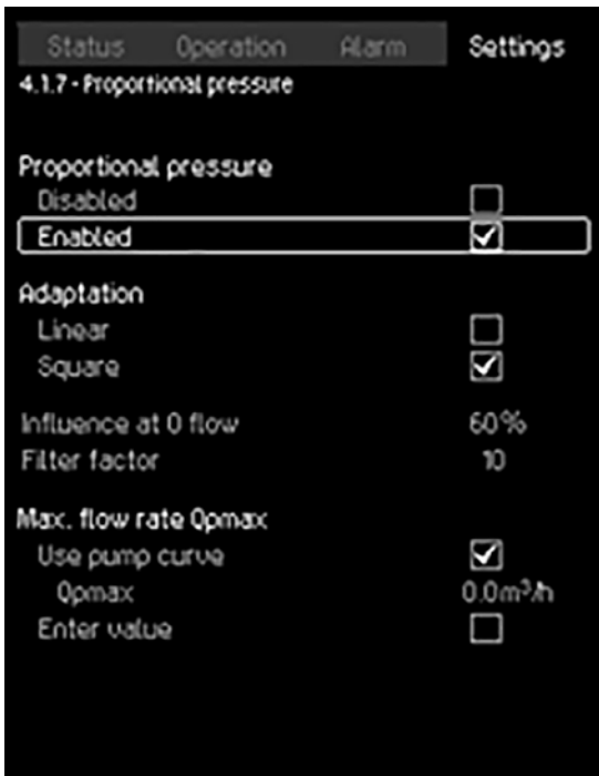
Hydro MPC proportionele druk instellingsmenu. Daarnaast kan het maximale debiet worden bepaald. Dit zorgt ervoor dat het systeemdebiet het nominale systeemdebiet niet overstijgt.
