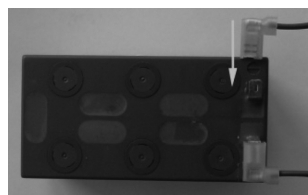
Afb. 19: Accu aansluiten (LevelControl Basic 2 BS)
