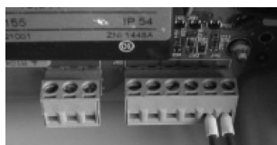
Afb. 15: Extern alarm aansluiten
