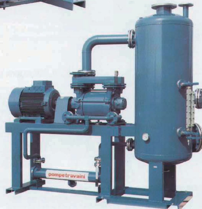
Gruppo autonomo per vuoto a circolazione totale di acqua serie HYDROSYS usato come compressore (pressione massima di funzionamento: 2 bar )
